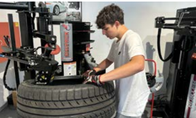
2 Bez využití pomocných ramen a korektního postupu montáže hrozí poškození disku i pneumatiky.
